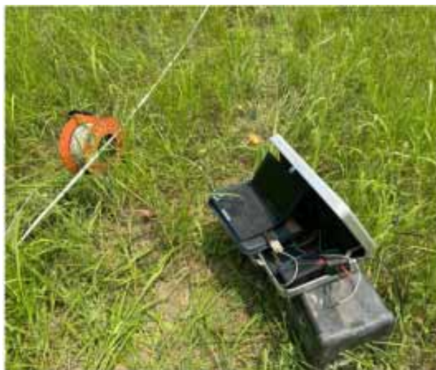
Foto allegata: Prospezione sismica combinata Rifrazione e Masw
